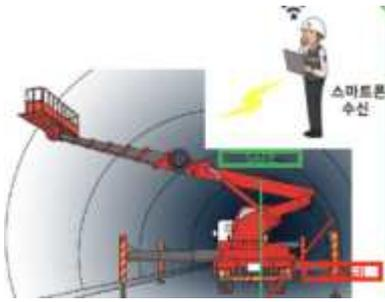
○ (지원목적) 차량탑재형 고소작업대에 “차량탑재형 고소작업대 스마트 통합전도방지시스템” 을 설치하여 깔림·끼임·전도 등에 의한 사고사망 감축에 기여
